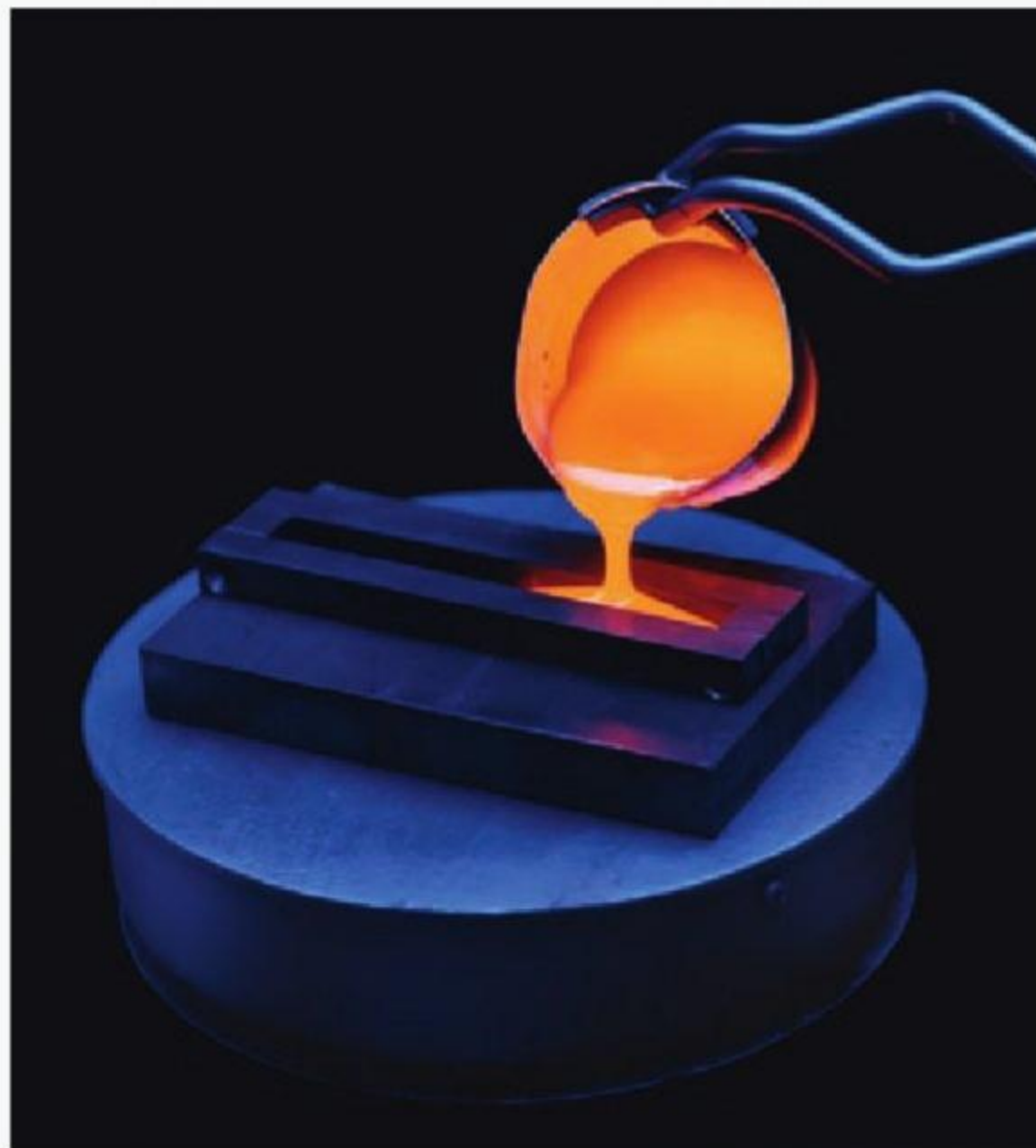
▲ Эксперимент по витрификации отходов (перевод в стеклообразное состояние)
